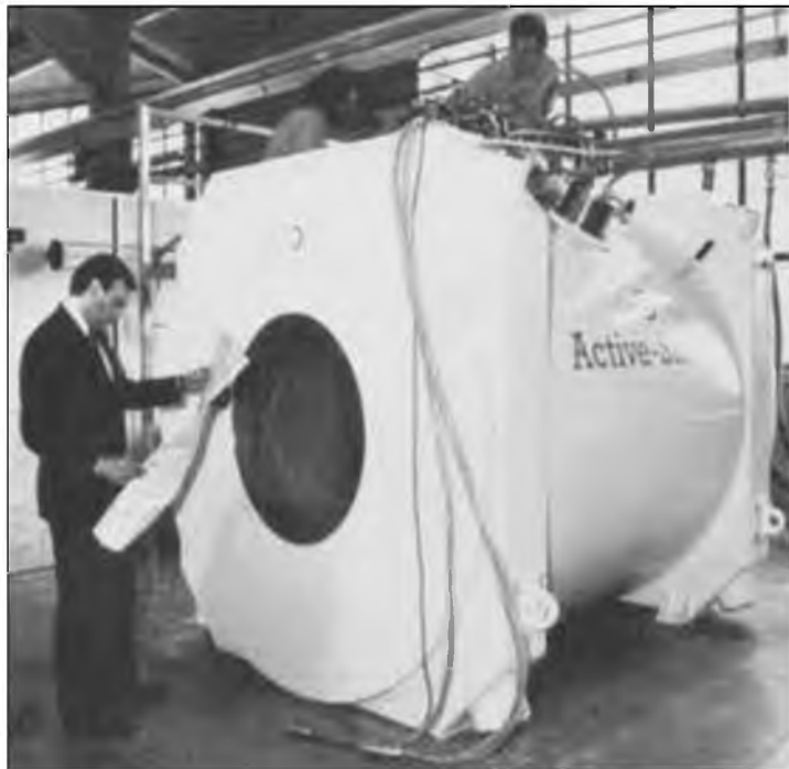
5.1-rasm. Insonni YaMR-tadqiq etish uchun tayyorlangan o'ta o'tkazuvchan solenoid
