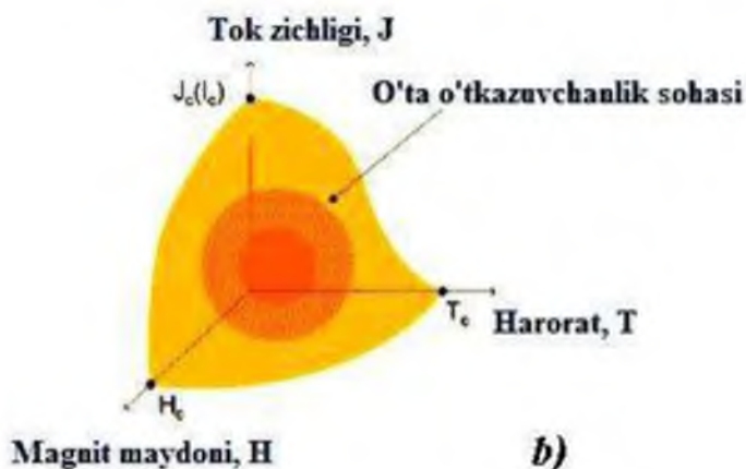
5.19-rasm. a) O'ta o'tkazgichlarni qo'llab ajratilayotgan loyihalar yillar bo'yicha erkin birliklarda keltirilgan. b) O'ta o'tkazuvchan materiallarda tok zichligi, harorat va magnit maydoni orasidagi bog'lanishini ifodalovchi chizma.
