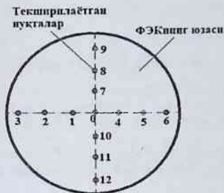
8-rasm. Svetodiiodni FEK yuzasi bo‘ylab turli nuqtalarga joylashtirilishi
