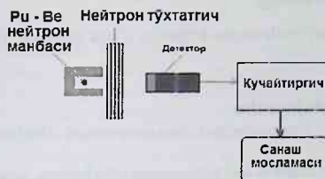
5-rasm. Tajribaning geometriyasi va blok-sxemasi
