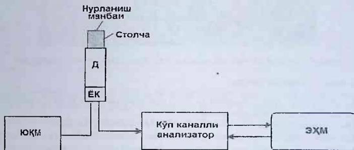
1-rasm. \gamma -spektrometning blok-sxemasi
