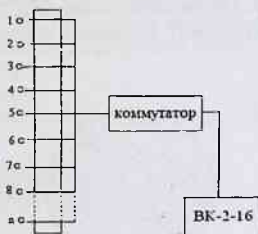
3 – rasm. Elektronlar oqimi zichligining fazoviy taqsimotini o'lchash sxemasi.
