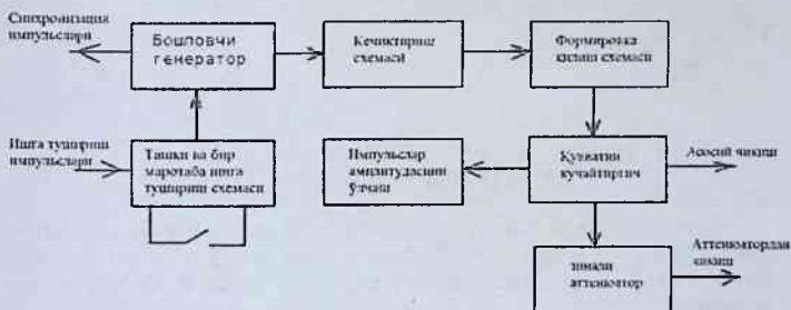
1-rasm. Impuls generatorining blok-sxemasini
