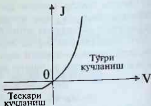
11.20- чизма. Металл-ярим ўтказгич контактнинг вольт-ампер тавсифномаси
