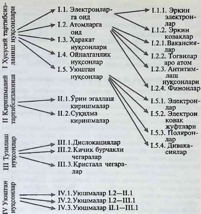
6.2 – чизма. Кристаллнинг тартибсизланиши бўйича нуқсонларнинг синфлари.
