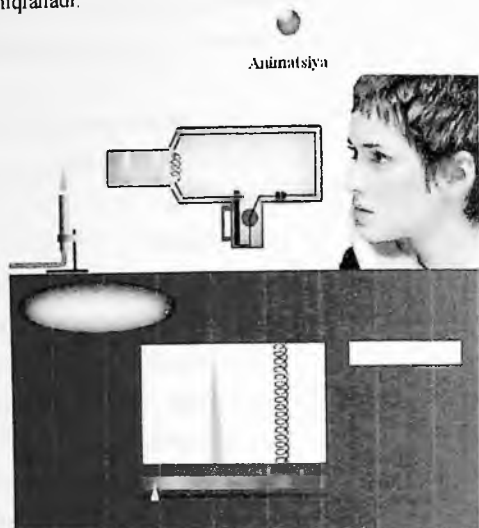
24.10-rasm. Optik pirometr yordamida neft mahsulotlarining yonish alangasi haroratlarini aniqlash laboratory qurilmasi sxemasi
