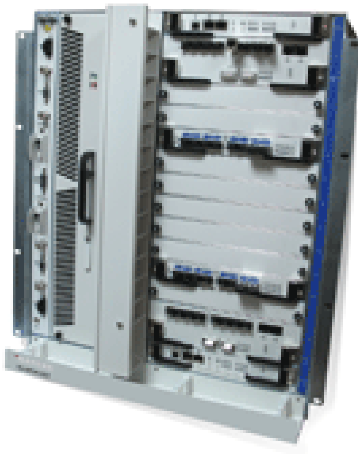
4.4-rasm. FG-GPON-OLT stansiya OLT qurilmasi
