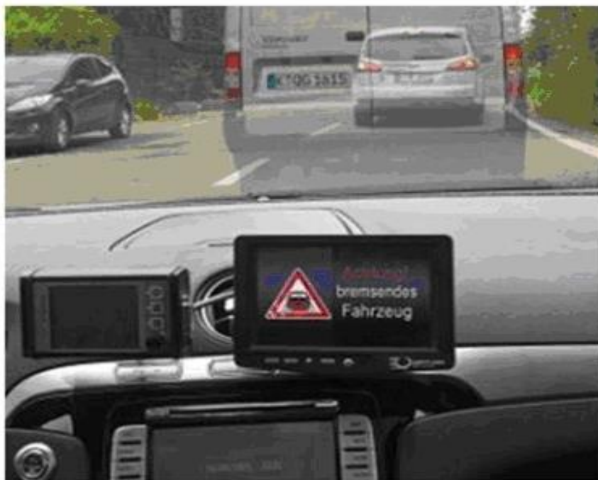
4.2 –rasm. LTE tarmog'i asosida avtomashinalar o'rtasidagi o'zaro aloqa
