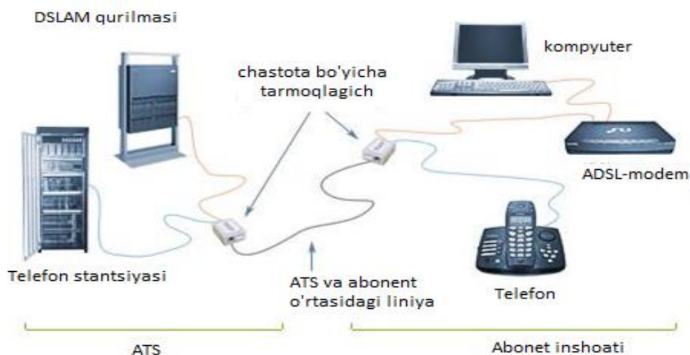
2.4-rasm. ADSL asosida raqamli abonent kirish tarmoqlarini qurishda qoʻllaniluvchi qurilmalarning ulanish ketma-ketligi ifodalangan
