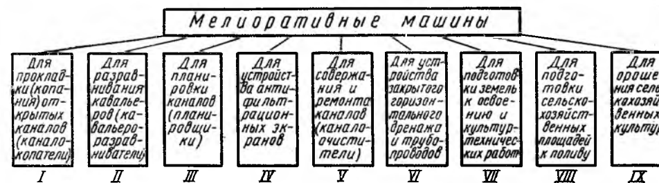
Рис. 1. Схема классификации мелиоративных машин по назначению.
