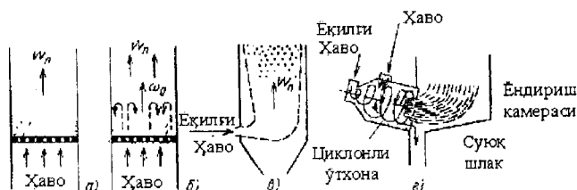
12.2 - расм. Қаттиқ ёқилғи ўтхоналари таснифи а) қатламли усул; б) қайнаётган қатламли усул; в) мангъалали усул; г) уюрмали усул.
