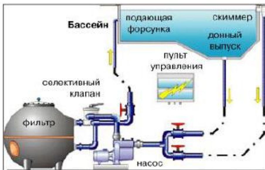
рис.74а Технологическая схема плавательного бассейна скиммерного типа
