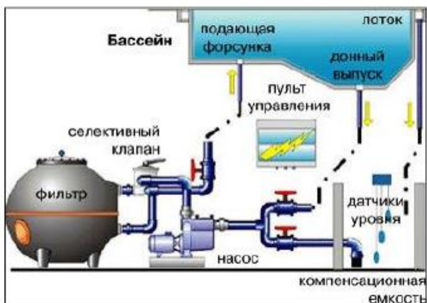
рис.74б Технологическая схема плавательного бассейна переливного типа
