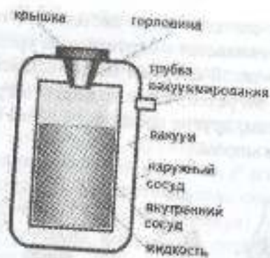
Рисунок 1.2 – Схема сосуда Дьюара
