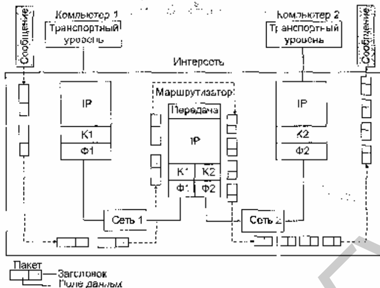
Рис. 13.10. Пример фрагментация IP-пакетов при передаче между сетями с разным максимальным размером кадра
