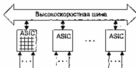
Рис. 9.35. Комбинирование архитектур коммутационной матрицы и общей шины
