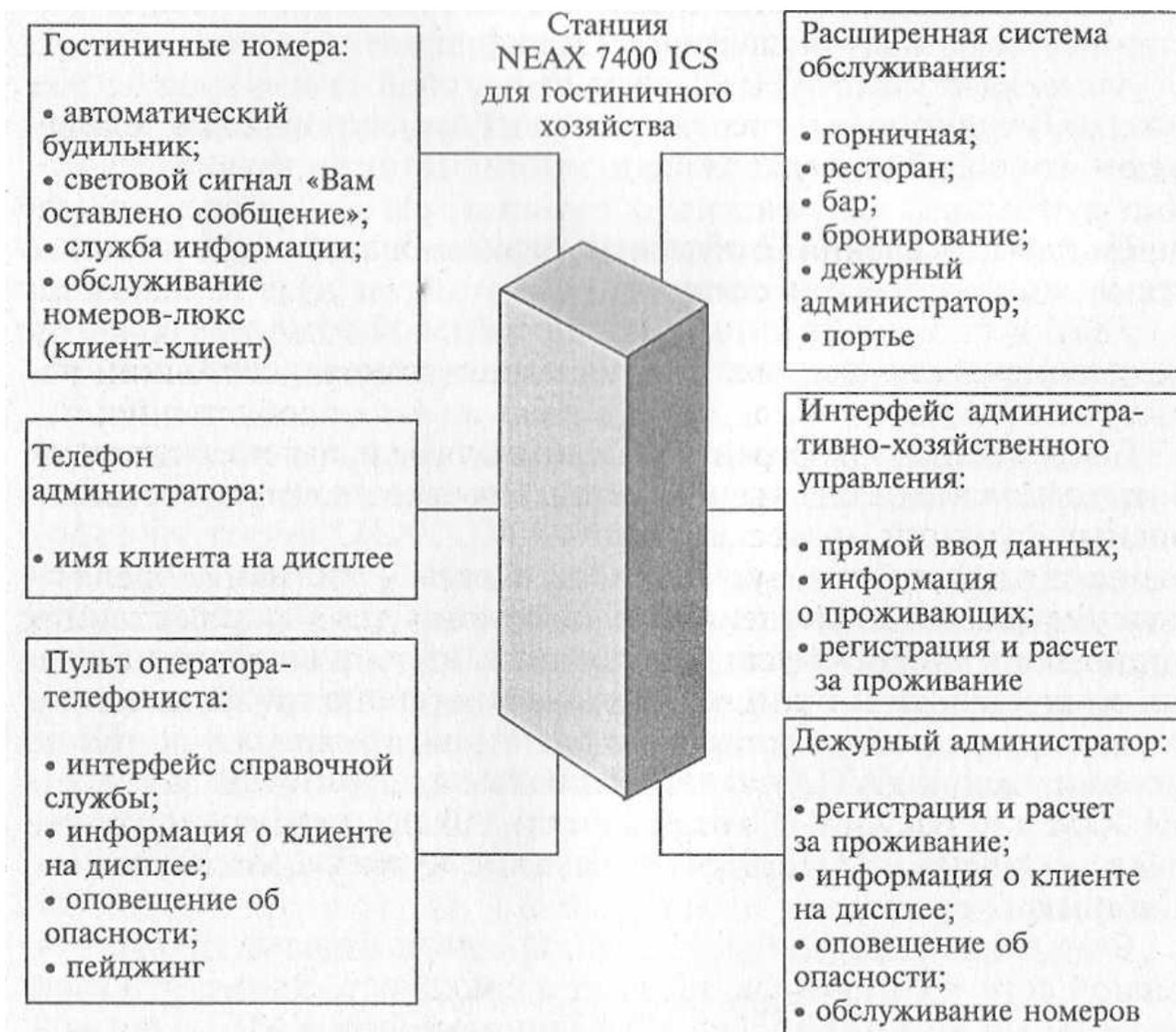
Рис. 6.20. Структурная схема приложения для гостиницы на примере станции Millenium NEAX 7400 ICS
