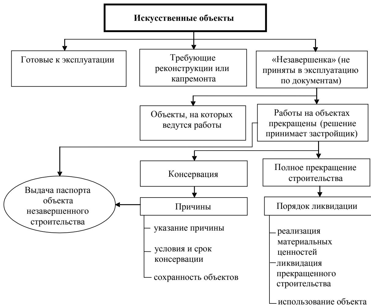
Рис. 3.2. Классификация искусственных объектов по готовности к эксплуатации
