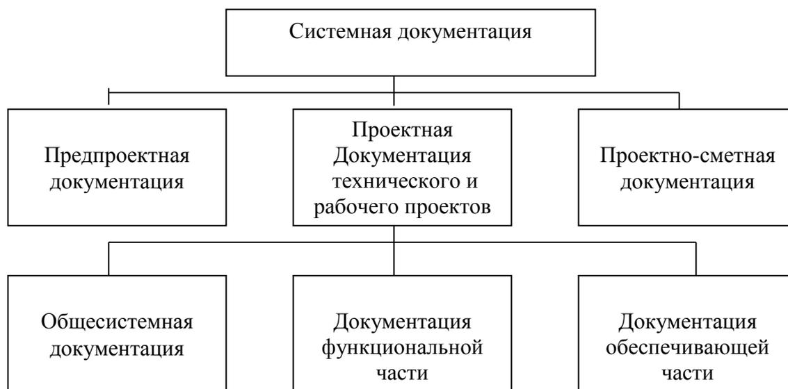
Рис. 11. Структура системной проектной документации.
