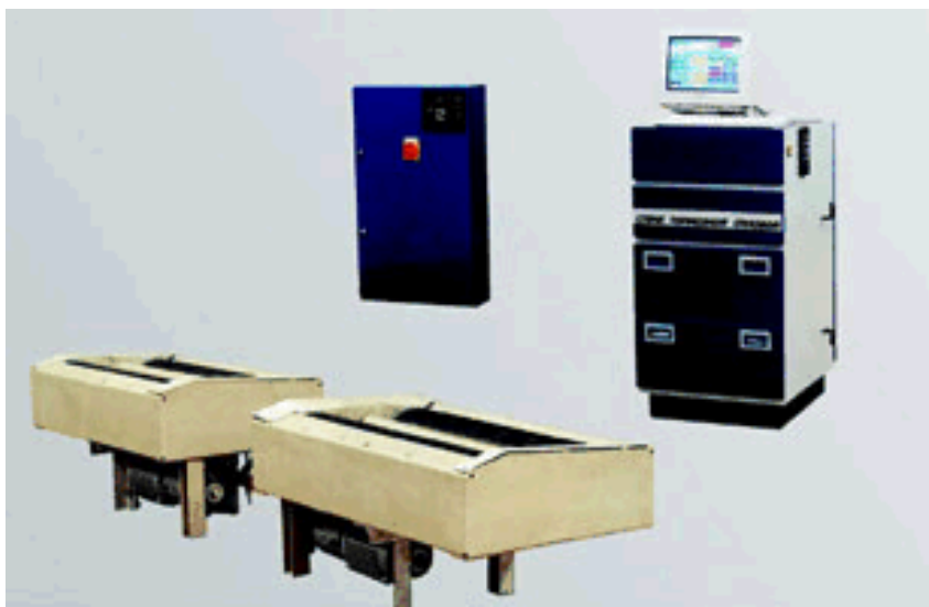
4.4-rasm. STS 10U-SP-11, rusumli engil va yuk avtomobillar, o'qiga 10 tonnadan ortiq yuklanish tushmaydigan avtobuslar va avtopoezdlar tormoz tizimini diagnostikalovchi qo'zg'almas universal qurilma
