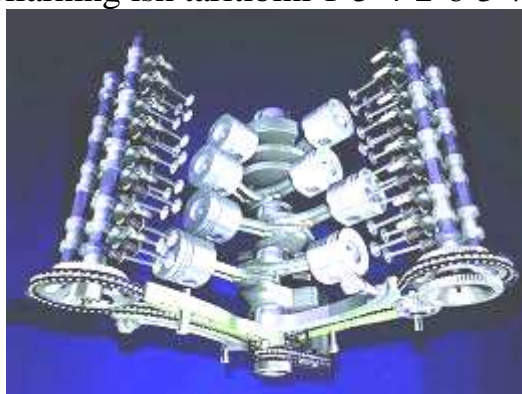
13.6-rasm. To'rt taktli sakkiz silindrli V – simon dvigatel krivoship-shatunli mexanizmning sxemasi.
