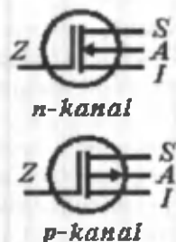
6.9-rasm. n – kanali qurilgan MDYA – tranzistor tuzilmasi (a), bunday tranzistorlarning shartli grafik belgilanishi (b).
