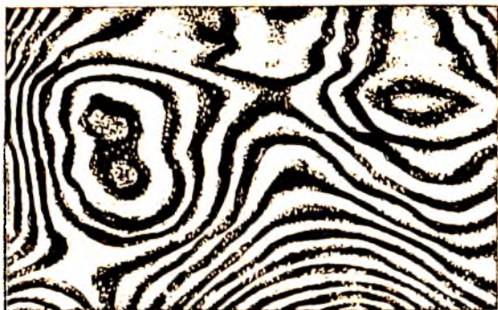
6.2- расм. Қалинлиги ҳамма жойда бир хил бўлмаган шиша пластинканинг икки сиртидан қайтган ёруғликда олинган интерференцион манзара.
