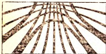
13.11- расм. Синуслар шarti бажарилишини текшириб кўришда ишлатиладиган синов буюми.
