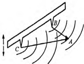
Рис. 4.16. Схематическое изображение опыта Юнга на поверхности воды
