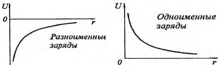
Рис. 7.26. Зависимость потенциальной энергии от расстояния между зарядами
