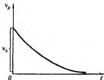
Рис 2.2. График зависимости скорости движения корабля в море при торможении его сопротивлением воды
