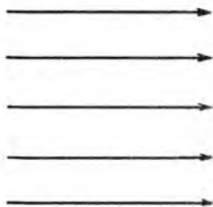
Рис. 7.4. Линии напряженности однородного поля
