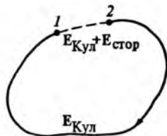
Рис. 7.33. Замкнутая электрическая цепь
