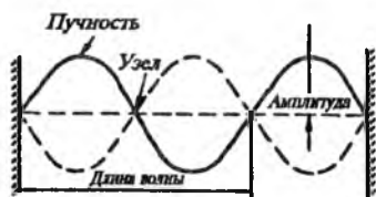
Рис. 4.28. Стоячая волна и ее характеристики
