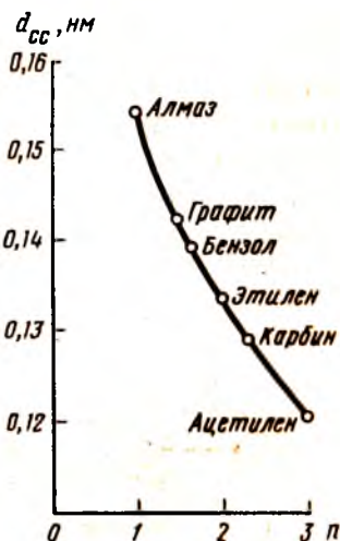
Рис. 174. Влияние порядка связи n на межъядерное расстояние в соединениях углерода
