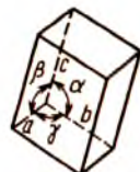
Триклинная a \neq b \neq c \alpha \neq \beta \neq \gamma \neq 90^\circ
