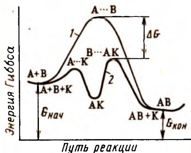
Р и с. 119. Энергетическая схема хода реакции в отсутствие и в присутствии катализатора
