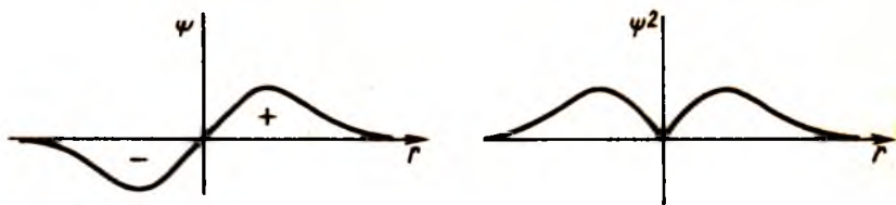
Р и с. 5. Графики \Psi и \Psi^2 для электрона атома водорода в возбужденном состоянии
