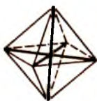
Кубическая a=b=c \alpha=\beta=\gamma=90^\circ
