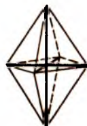
Тетрагональная a=b \neq c \alpha=\beta=\gamma=90^\circ
