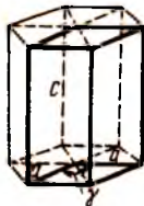
Гексагональная a=b \neq c \alpha=\beta=90^\circ \gamma=120^\circ
