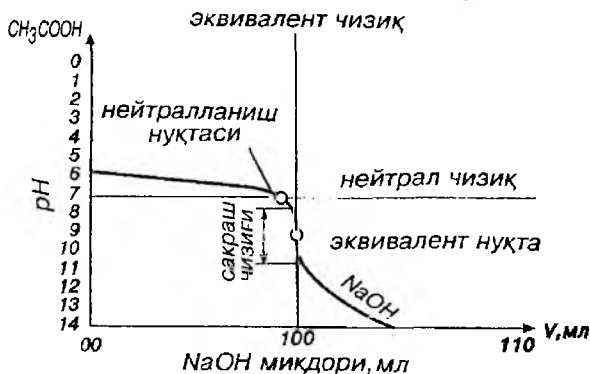
2.16-расм. \text{CH}_3\text{COOH} ning 0,1 н эритмасини \text{NaOH} ning 0,1 н эритмаси билан титрлаш эгри чизиғи.
