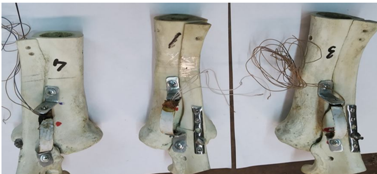
3.16-rasm. O'rnatilgan o'lchash datchiklari bilan sinov namunalari.
