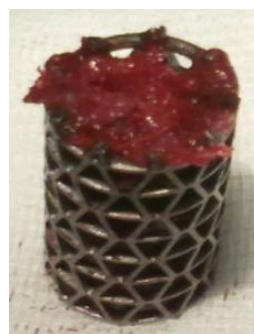
Рис. 5. Титановый сетчатый кейдж (piramesh) заполнен костью в виде параллелепипеда (слева) и костной крошки (справа).
