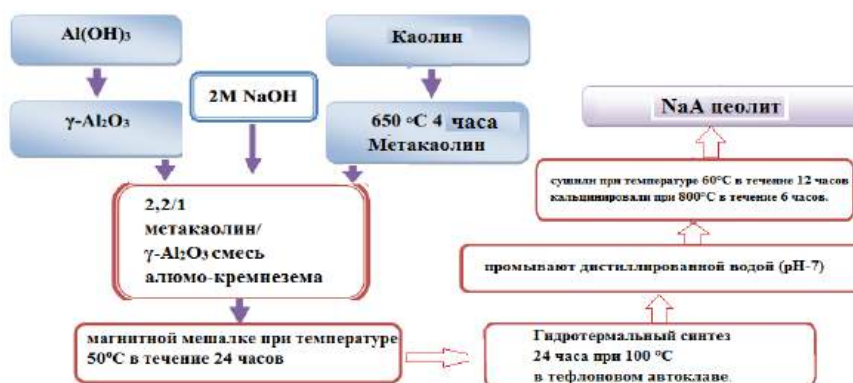
Рис.1. Схема получения синтетического цеолита NaA
