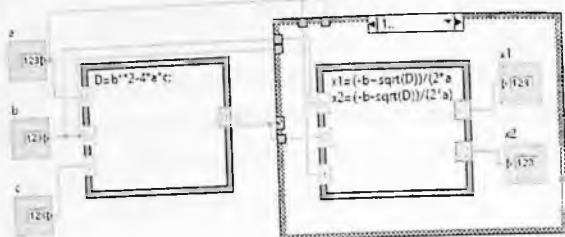
2.13.2-rasm. VU ning D > 0 holatidagi diagramma bloki sxemasi.
